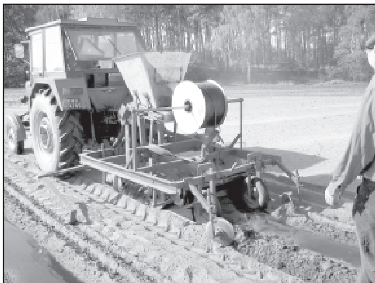
Maszyna do nawożenia i układania czarnej folii w międzyrzędziach wykonana z na bazie siewnika do nawozów - Fot. J. Krawczyk
