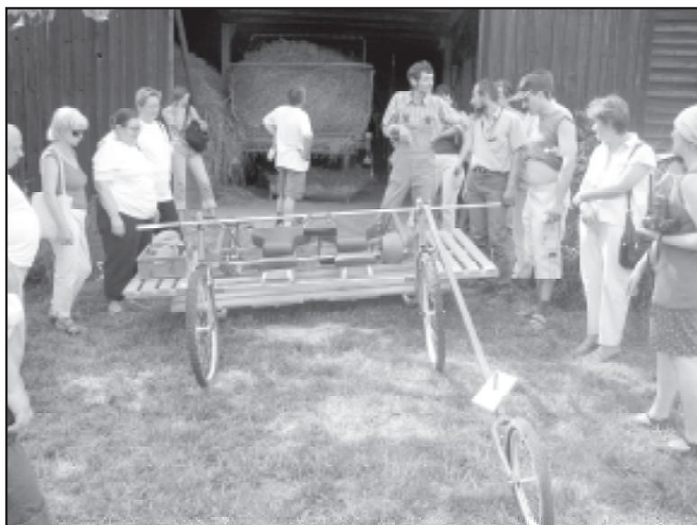
Platforma rowerowa usprawniająca ręczne sadzenie, pielnie (Saksonia DE) - Fot. M. Krysztoforski
